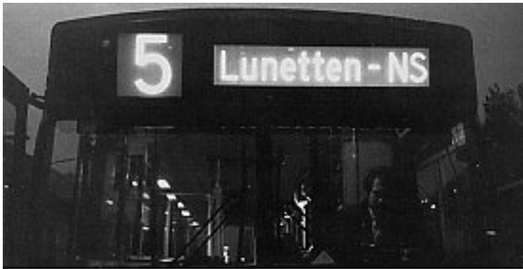
Figuur 4.20: Overstraling op de koersrollen van bussen.
