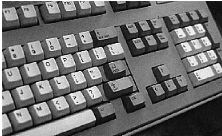
Figuur 4.3: Een toetsenbord met een kleine 'enter' toets.
