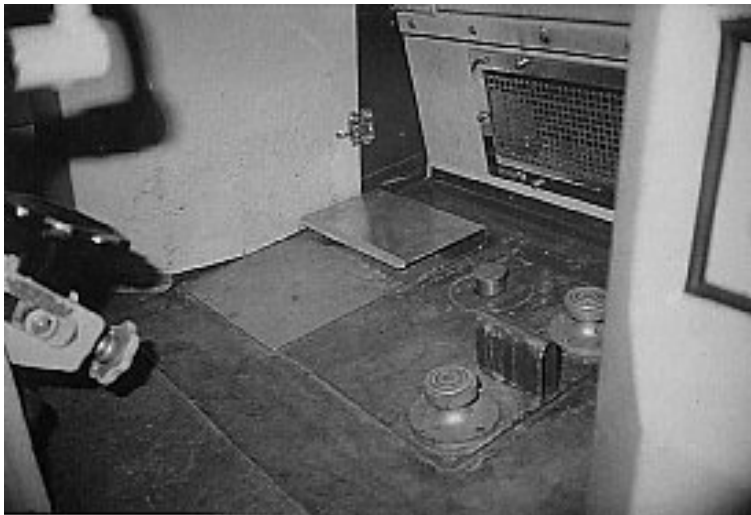
Figuur 6.18: De 'intermitterende dodemanspedaal': de vlakke pedaal links.
