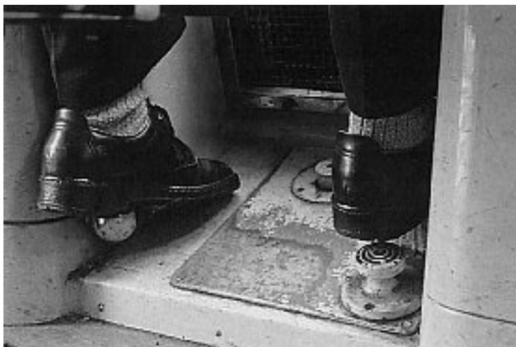
Figuur 6.17: Bediening van de 'continue dodemanspedaal' met de linkervoet. De pedaal is bolvormig en vergt een vrij hoge indrukkkracht.
