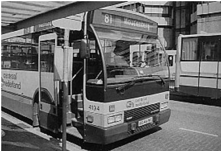
Figuur 6.15: De gekromde ruit van de stads- en streekbussen: uitgekiend om reflectiehinder te voorkomen.
