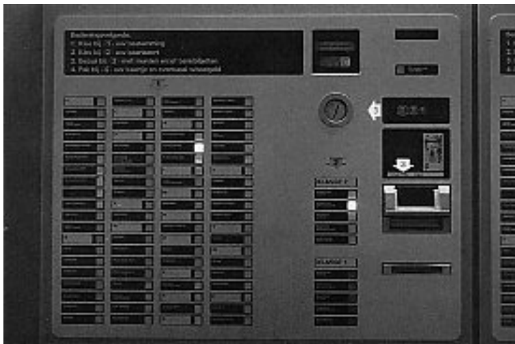
Figuur 4.23: Het front van een kaartjesautomaat; Knipperende cijfers benadrukken de bedieningsvolgorde.
