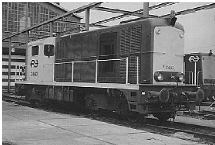
Figuur 6.19: Een ouder type NS diesellokomotief: de hoge neus belemmert het uitzicht.
