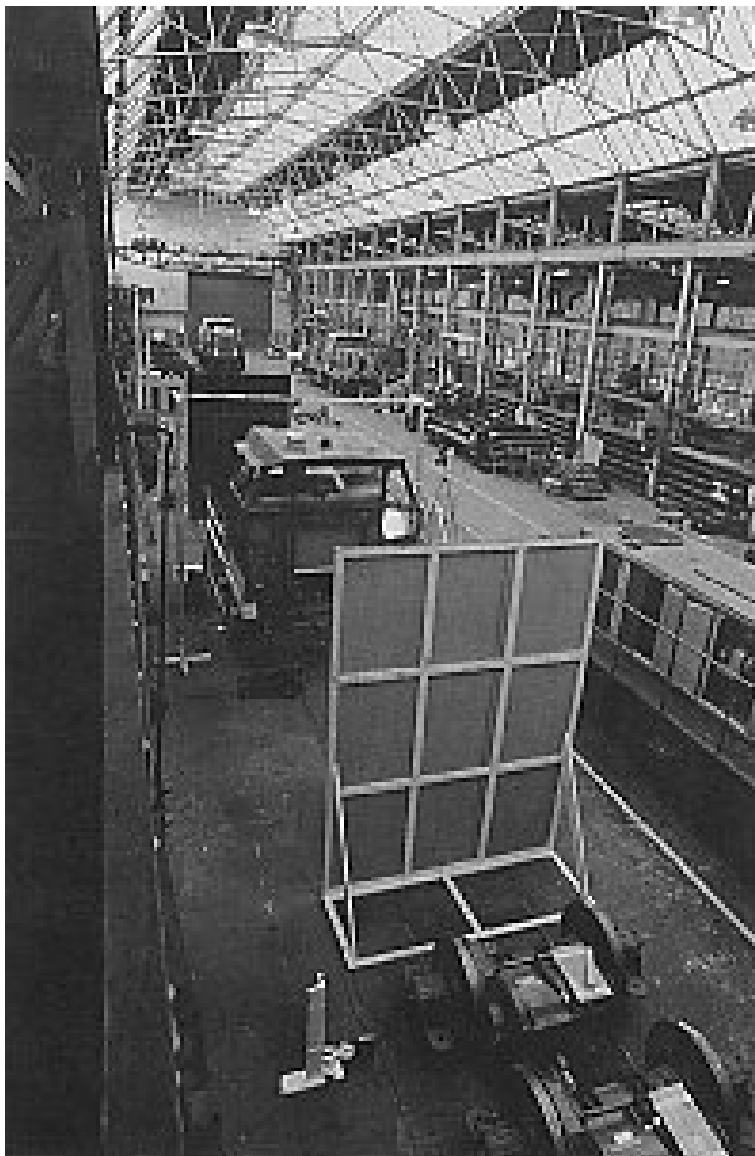
Figuur 6.26: De mock-up van de cabine van de serie 6400 diesellokomotief.
