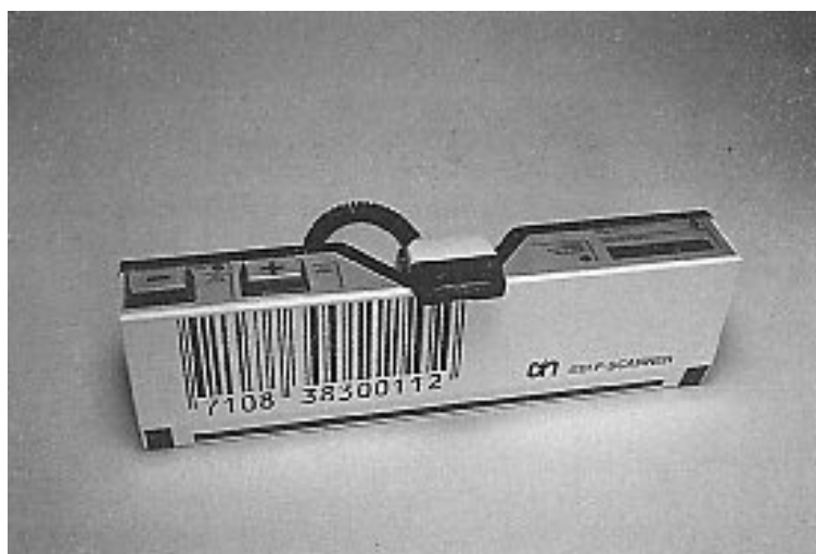
Figuur 5.11: De self-scanner; de streepjescodelezer bevindt zich in een uitsparing in de behuizing.
