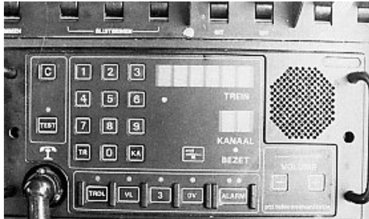
Figuur 4.9: Het Telerail-apparaat voor communicatie tussen de machinist en de treinverkeersleiding.
