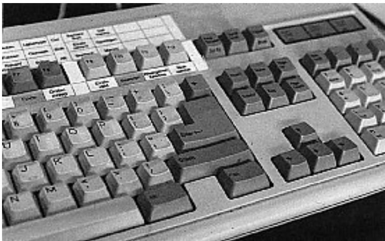
Figuur 4.2: Een toetsenbord met een grote 'enter' toets.
