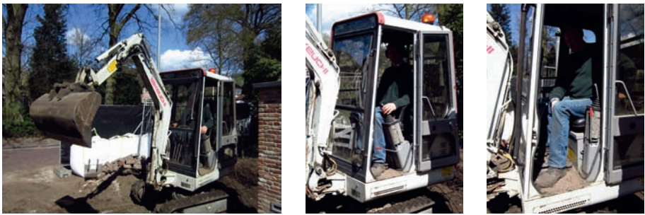
Figuur 5.75 De cabine van deze graafmachine is zo klein dat de linker bedieningsknop de toegankelijkheid van de cabine hindert. Het bedieningsmiddel is daarom opklapbaar gemaakt.
