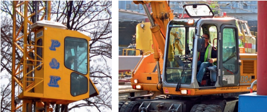
Figuur 5.73 Verschillende opties voor ventilatie. Links: gesloten kraancabine met airconditioning. Rechts: graafmachine met deur en zonnedak open.
