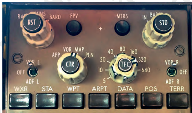
Figuur 7.103 De twee gelijken knoppen in de cockpit van een Boeing 747: 'RST' en 'STD', zie kader hierboven.
